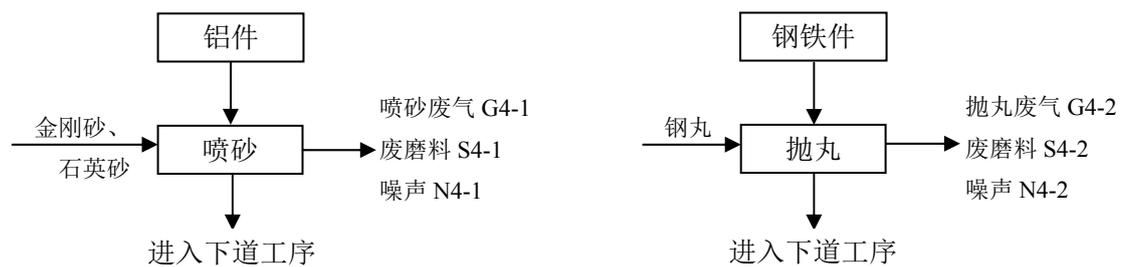
图 5-4 喷砂、抛丸工艺流程图
